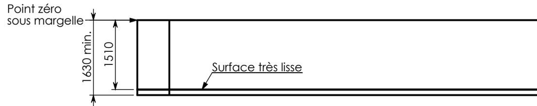
Radier de 120mm minimum en béton armé ou fibré, dosé 350kg de ciment par m3
