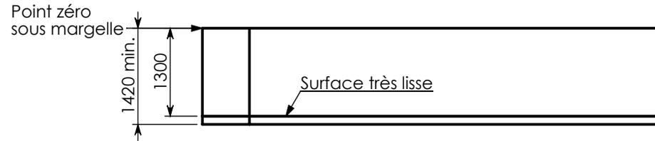
Radier de 120mm minimum en béton armé ou fibré, dosé 350kg de ciment par m3
