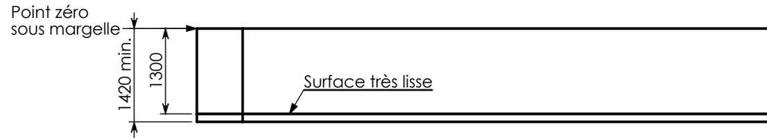
Radier de 120mm minimum en béton armé ou fibré, dosé 350kg de ciment par m3
