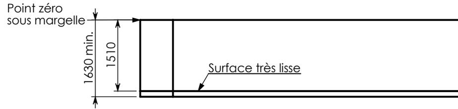
Radier de 120mm minimum en béton armé ou fibré, dosé 350kg de ciment par m3
